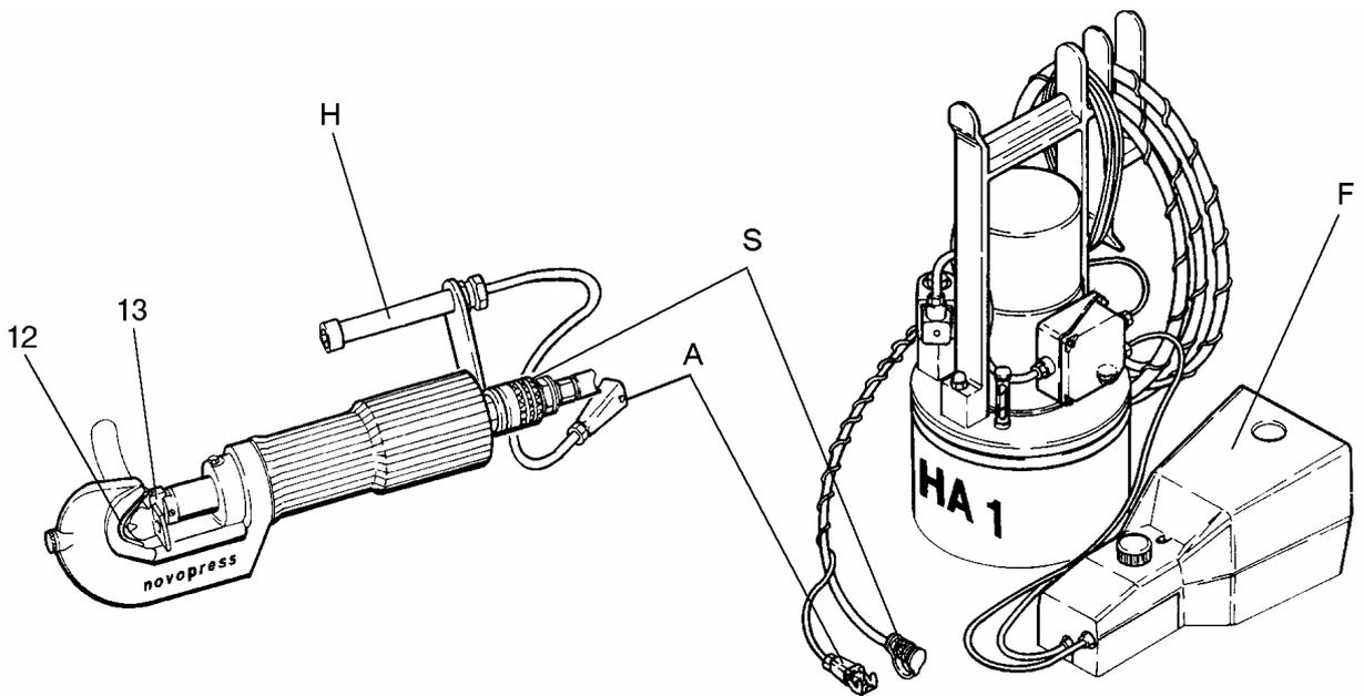
1. Den Verpreßzylinder über die Schnellkupplung (S) mit dem Hydraulikaggregat HA 1 verbinden.
